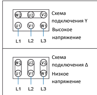
Трехфазный двигатель
