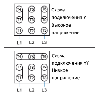
Трехфазный двигатель NEMA (230 / 460V)
