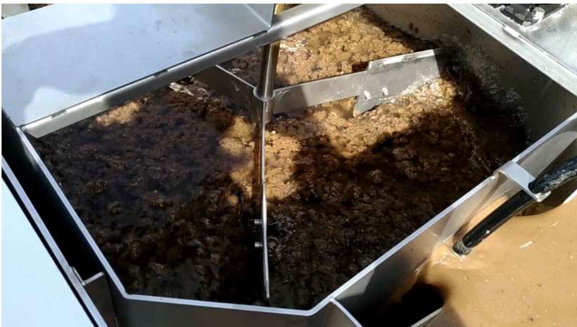
Fig. 13 : Effet de polymère : flocs optimaux
