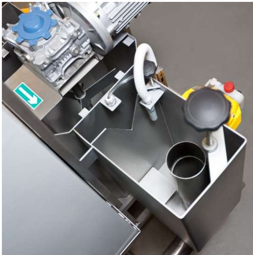
Fig. 7 - Réglage du niveau de trop-plein dans la cuve d'alimentation
