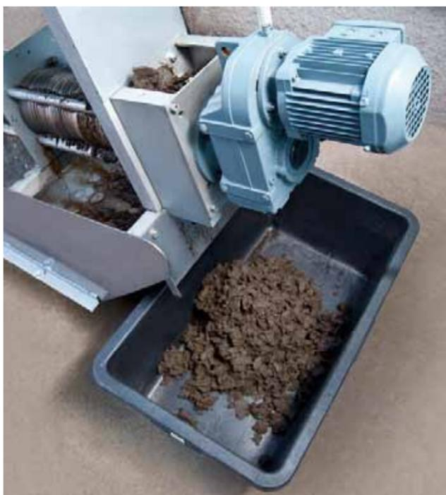
Tandis que les plaques mobiles assurent un autonettoyage continu, la vis est en mouvement. En terme de structure, des plaques fixes et des cales d'espacement sont alignées sur des arbres, des disques fixes et mobiles sont alternés. Les disques mobiles effectuent un mouvement planétaire tout au long du fonctionnement de la vis.
